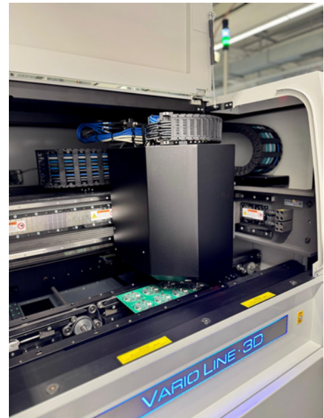
Herzstück der AOI-Anlage: 3D/2D-Kamerakopf
